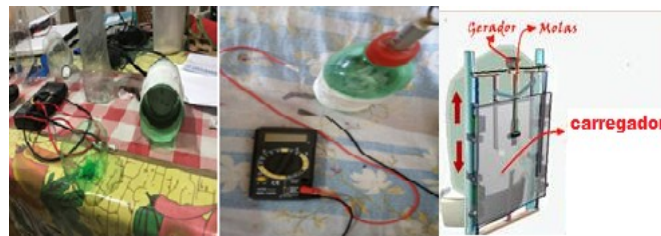
Figura 1. Protótipo conectado ao multímetro. Autoria: Emanuely Niklen Bruno Reis (2017)
